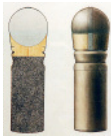
Das Vollkugelgeschoss aus Eisen der Sechspfünder-Vorderlader-Artilleriekanone, Ordonnanz 1843, wie es 1866 in Murten zum Einsatz gelangte (Kugelgewicht 2,860 kg, Schwarzpulverladung 750 g, Mündungsgeschwindigkeit 435 m/s).
